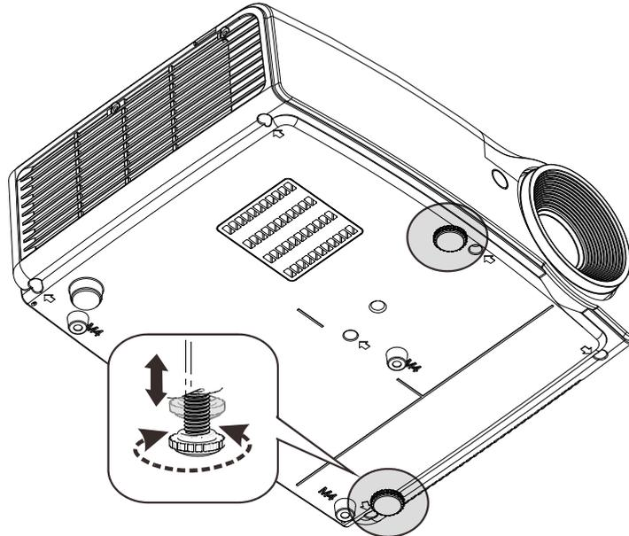
Para ajustar el ángulo de la imagen, gire el control de inclinación a la derecha o a la izquierda hasta alcanzar el ángulo deseado.
